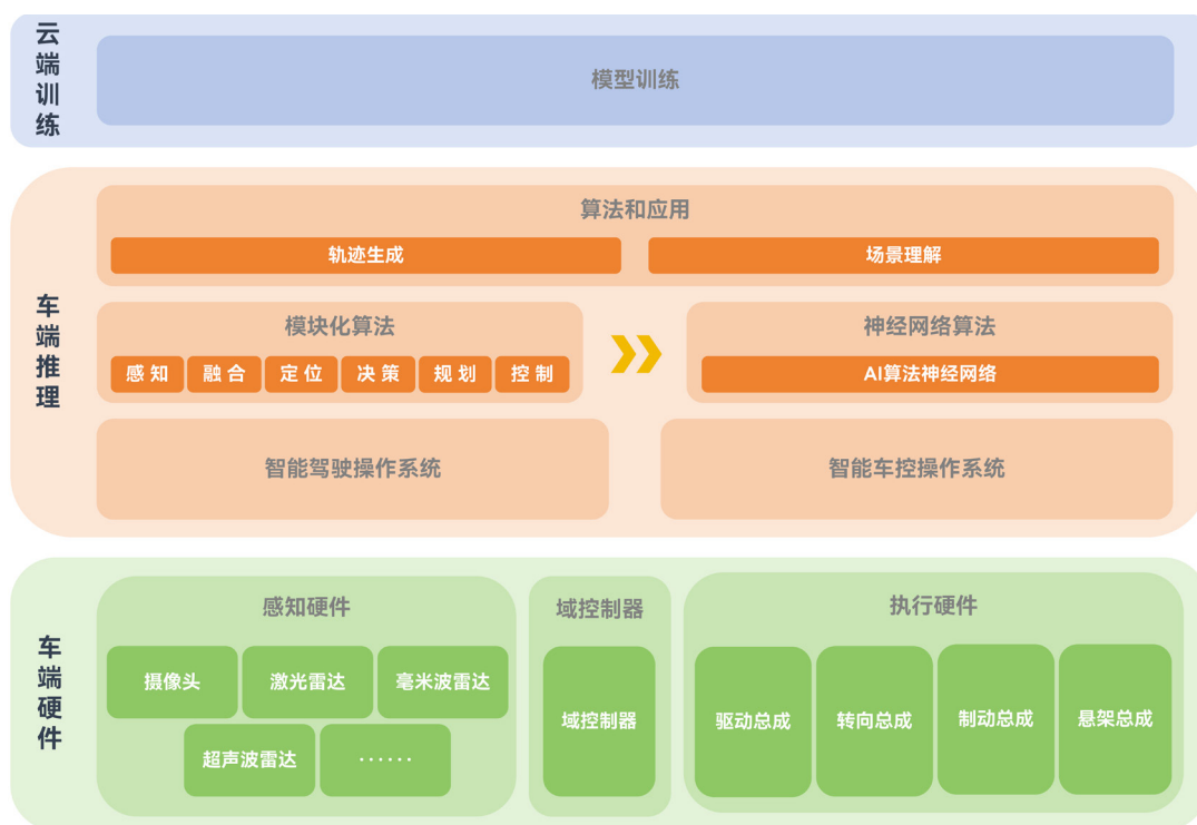
图 2-1 智能驾驶系统关键技术架构图
