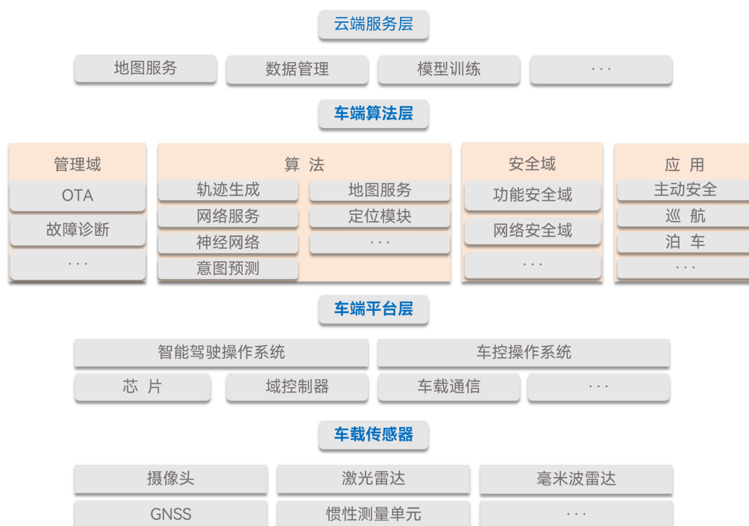
图 1-2 智能驾驶整体技术架构图
